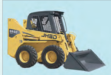
스키드로더 skid-steer loader 스키드로더로 폐기물을 치웁니다. Clear up waste matter with a skid-steer loader.
